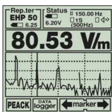
Visualizzazione sullo strumento dello spettro di frequenza
